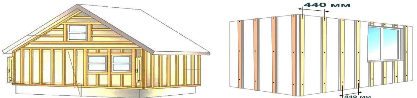
Для утепления дома можно использовать утеплитель на наружной стороне стены. Пространство между рейками заполняется утеплителем, при этом он должен быть защищен специальной гидроизоляционной пленкой.
