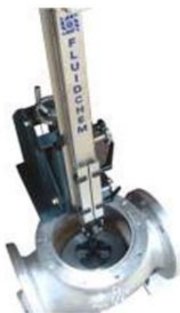
Станок шлифует седло запорного вентиля
