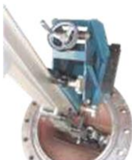
Обработка сёдел задвижки
