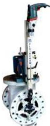
Станок шлифует магистральный фланец
