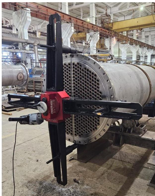
Рисунок: Станок FMFF-1200 в работе на производственной площадке Заказчика (Россия).
